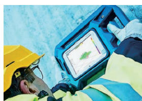
写真-8 超音波アレイP波 による探査例
