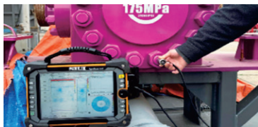
写真-11 ボルト探傷例
