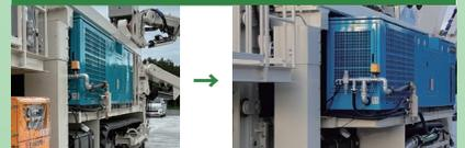
ヘラクレス専用設計した75kW+37kW静音型高効率コンプレッサを搭載。
