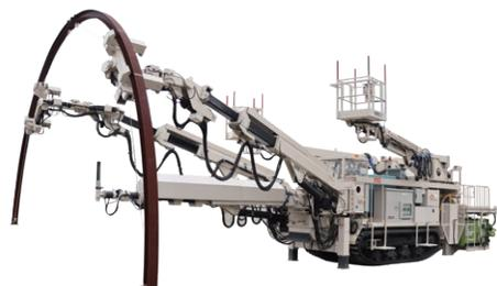
ヘラクレス MF 最大吹付範囲：幅 16060mm 高さ 9665mm
