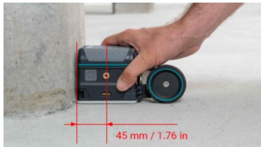
写真②-壁際 45mm まで探査可能
